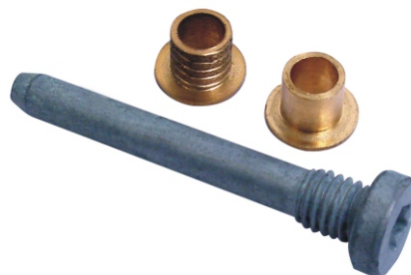
Perno de bisagra r-19 / Clio (con bujes)
