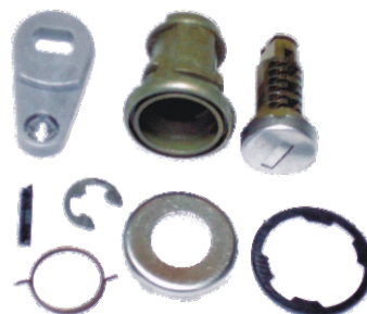
Kit puerta Renault Clio/21 (cilindro, buje y varios)s/comb
