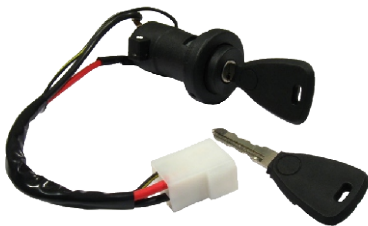
Cerradura ignición completa camión Mercedes Benz 85/95.
