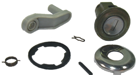
Kit puerta Peugeot 505 (cilindro, buje y varios)s/comb.
