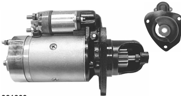
301060 REEMPLAZO ARR. DELCO-REMY - MÁQUINAS VIALES, ETC. 24V-Z12-Ø46 - Ref. DIPRA
