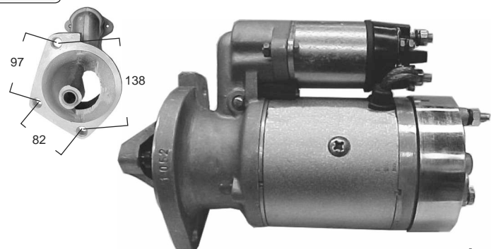
301069 CAMIÓN NISSAN CPC 14- MOTOR 6CIL. DODGE MOTOR NISSAN LD30 24V-Z11-Ø39,5 - Ref. AN115
