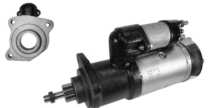
301469/10 FIAT 400-500-etc - DEUTZ 55 - Reemplazo BNG - CAV - 12V-Z10-Ø38,5
