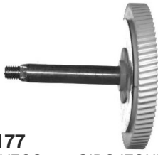
LP1171 GOL, GACEL, PEUGEOT 504/505 GIRO IZQUIERDO - EQUIPO MMA. ENGRANAJE: Z88 Ø66.3MM. EJE: LARGO 51.3MM. Ø10MM.
