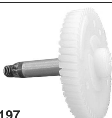
LP1197 FORD TRANSIT. ENGRANAJE: Z55 Ø57.4MM. EJE: LARGO 47.7MM. Ø10MM.
