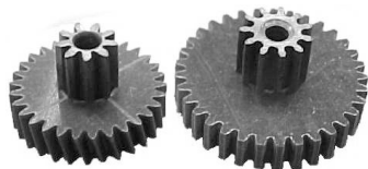
LP1072 DODGE 1500. ENGRANAJE GRANDE: Z33/11 Ø21.5/7.8MM. ENGRANAJE CHICO: Z30/9 Ø17.3/6.6MM.
