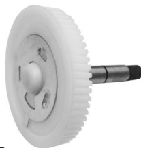
LP1166 TRAFIC, M. BENZ, BOSCH. ENGRANAJE: Z63 Ø64.8MM. EJE: LARGO 61.3MM. Ø10MM.
