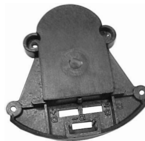
P7032 TAPA PORTAESCOBILLAS ALTERNADOR TIPO INDIEL
