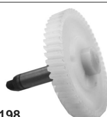
LP1198 CITROEN C15. ENGRANAJE: Z54 Ø57.6MM. EJE: LARGO 45.3MM. Ø10MM.
