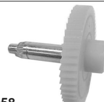
LP1058 DODGE CAMION, POLARA, FIAT - EQUIPO TEG TODOS. ENGRANAJE: Z51 Ø52.8MM. EJE: LARGO 42.6MM. Ø10MM.
